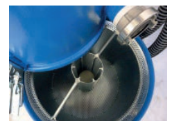
Spänekorb, aus Lochblech mit Ø 3 mm-Lochung gefertigt und mit integriertem mechanischem Schwimmer ausgestattet.
